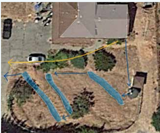
Figura 5-16: Ejemplo de biocanal de drenaje rural (Fuente: Sebastian Bertsch/Google Earth)
